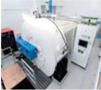
図7 PREP 粉末製造装置
